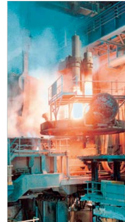
Electrodos de carbono en funcionamiento
