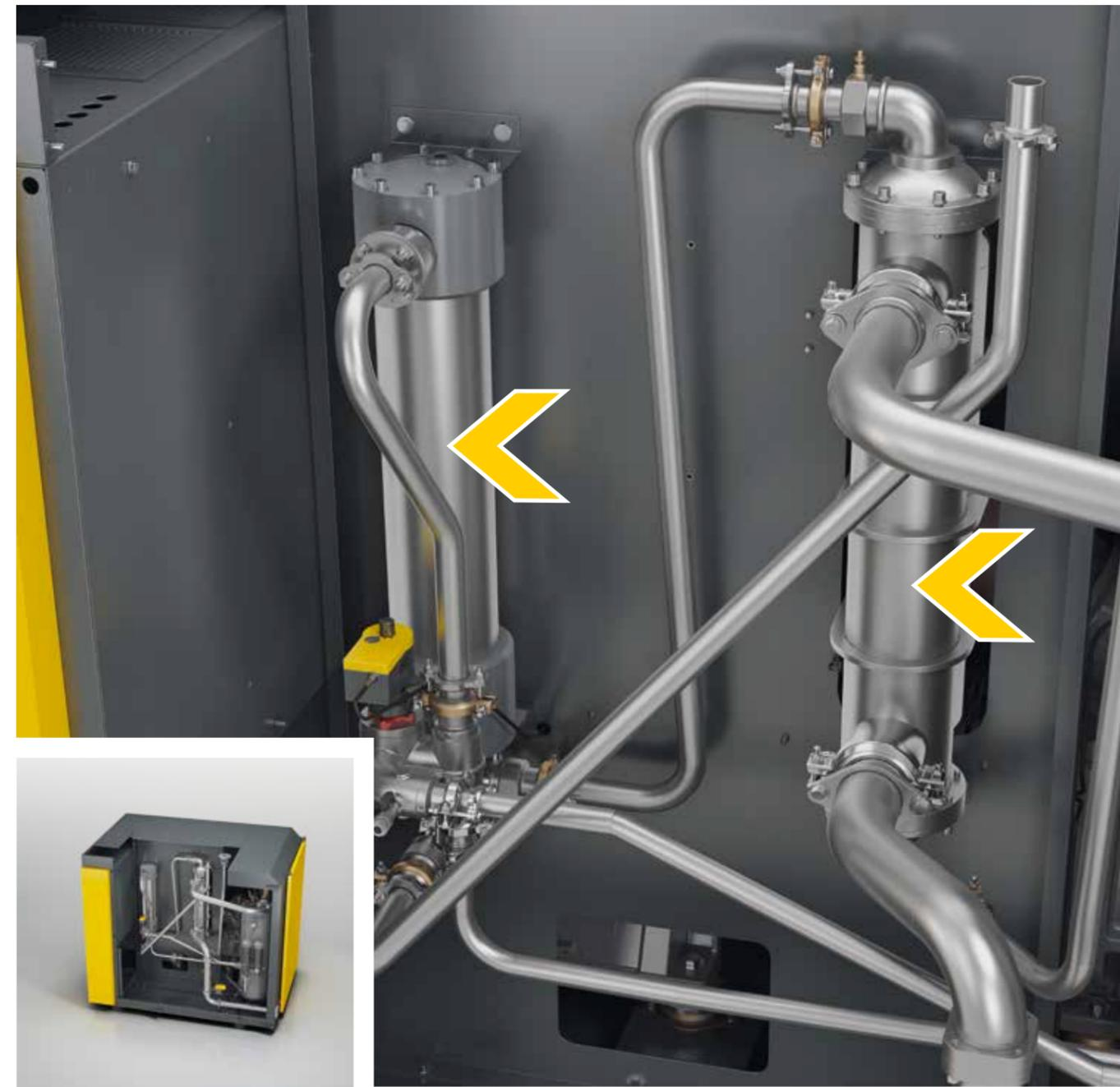
Intercambiador de calor tubular de aleación de cobre-níquel (CuNi10Fe) son igual de eficaces que los intercambiadores de placas, pero menos sensibles a las suciedad, más robustos y resistentes a la limpieza mecánica. Ade-
