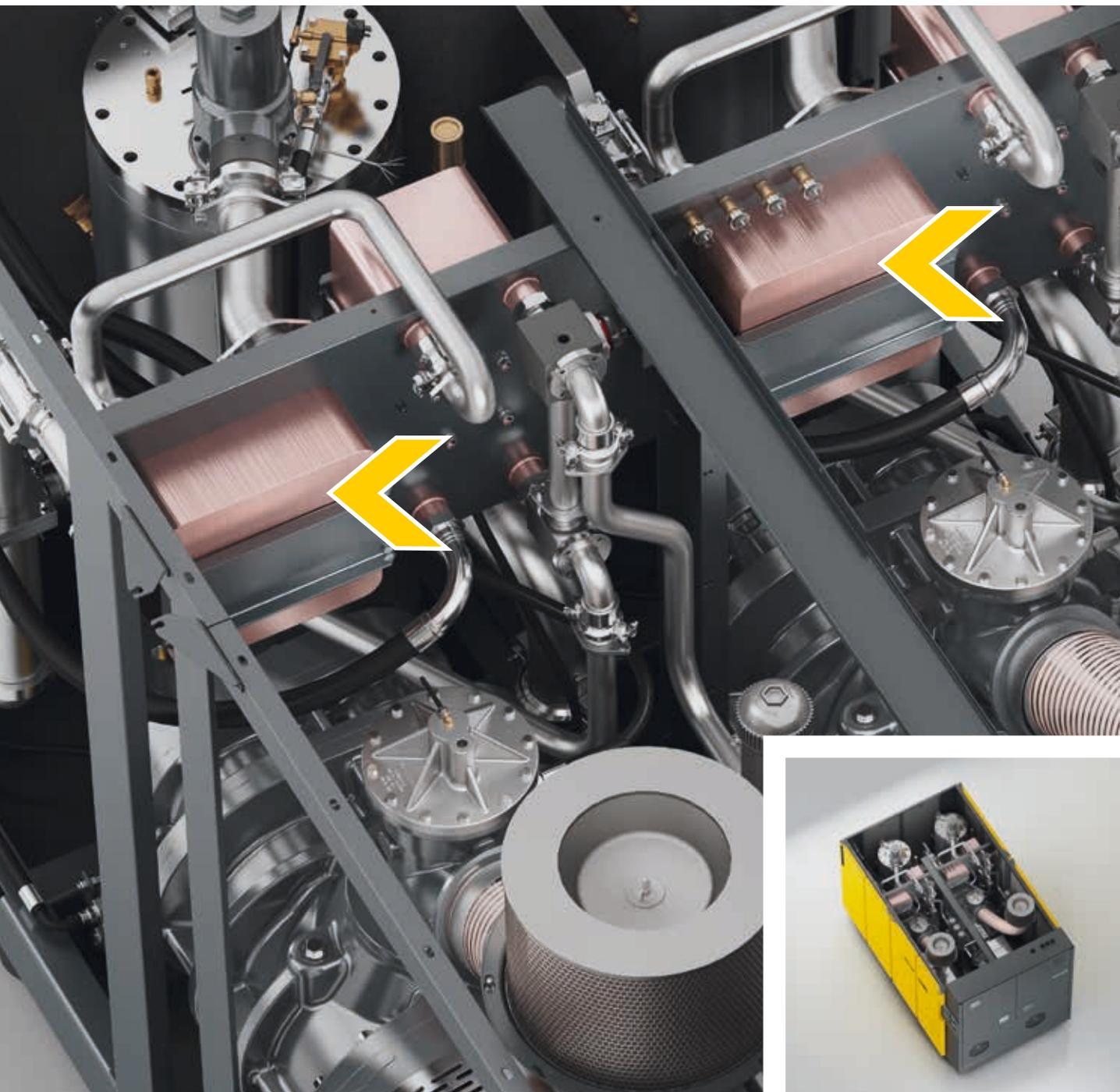
Dos intercambiadores de calor de placas de acero inoxidable soldadas con cobre procuran una muy buena derivación del calor gracias al relieve de la superficie de las placas. La mejor elección para aplicaciones con agua de refrigeración limpia.
