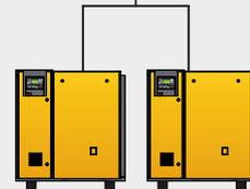
Conexión de compresores con SIGMA CONTROL, conexión a estaciones con red Profibus (en sustitución del SIGMA AIR MANAGER 1)
