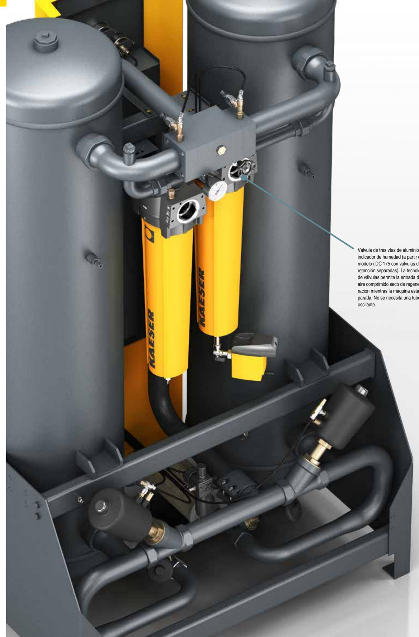
Válvula de tres vías de aluminio e indicador de humedad (a partir del modelo i.DC 175 con válvulas de retención separadas). La tecnología de válvulas permite la entrada de aire comprimido seco de regeneración mientras la máquina está parada. No se necesita una tubería oscilante.
